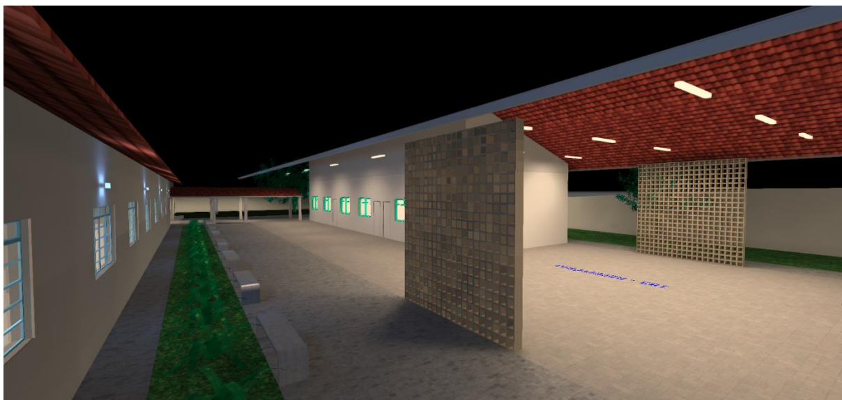
Figura 26 - Resultado da Simulação no Dialux (Cores Reais) – Refeitório
